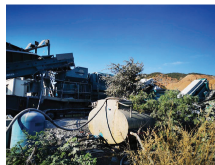
รูปที่ 2-29: การติดตั้งถังคั่นน้ำ บริเวณ Mobile Crushing
